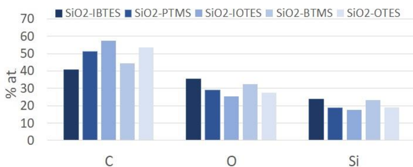
Rysunek 17. Procentowa zawartość atomowa pierwiastków wyznaczona na podstawie pomiarów XPS w warstwach serii pierwszej.
